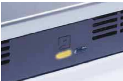
Wartungsanzeige (hier wird das „Wartungssymbol“ abgebildet): Gelb = Störung (Service erforderlich). Gelb blinkend = Wartung oder Verschmutzungszustand (Service erforderlich).
