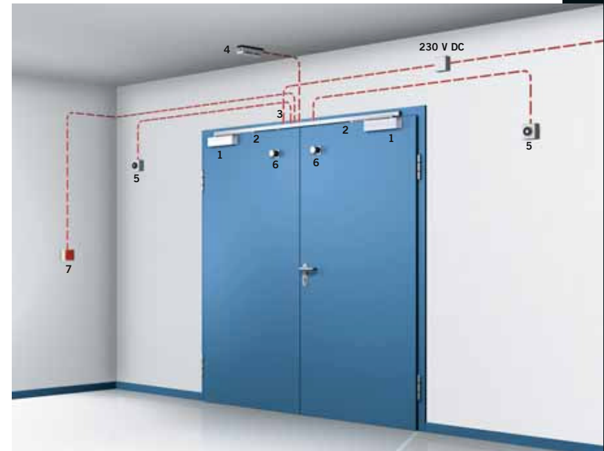
Anwendungsbeispiel: Feststellanlage an einer 2-flügeligen Feuer- und Rauchschutztür, bestehend aus 2 Türschließern DORMA TS 93 B (1), Gang- und Standflügel-Gleitschiene DORMA G-SR/EMF (2) mit Schubstangen-Klemmsystem, Rauchmeldezentrale DORMA RMZ (3) auf Gleitschiene bzw. Verkleidung montiert sowie je 1 Rauchmelder DORMA RM (4) als Deckenmelder auf beiden Seiten der Tür, Elektromagneten DORMA EM 500 G (5), Teleskopankern DORMA MAT (6), Handauslösetaster DORMA HT (7)
